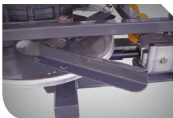
Pás do sistema centrífugo em aço carbono tratado termicamente, opcional metalizado, com distribuição em largura variável de 18 a 36 metros, podendo ser ajustado com a largura das barras dos pulverizadores, reduzindo o índice de amassamento na lavoura. Regulagem rápida e fácil do ângulo das pás sem o uso de ferramentas.
