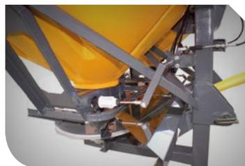
Regulagem rápida da dosagem, por meio de limitador roscado e indicação escalonada.
