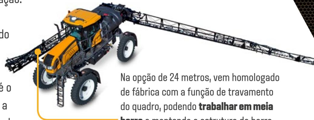
Na opção de 24 metros, vem homologado de fábrica com a função de travamento do quadro, podendo **trabalhar em meia barra** e mantendo a estrutura da barra intacta. A função atende a uma demanda do mercado sucroalcooleiro.
