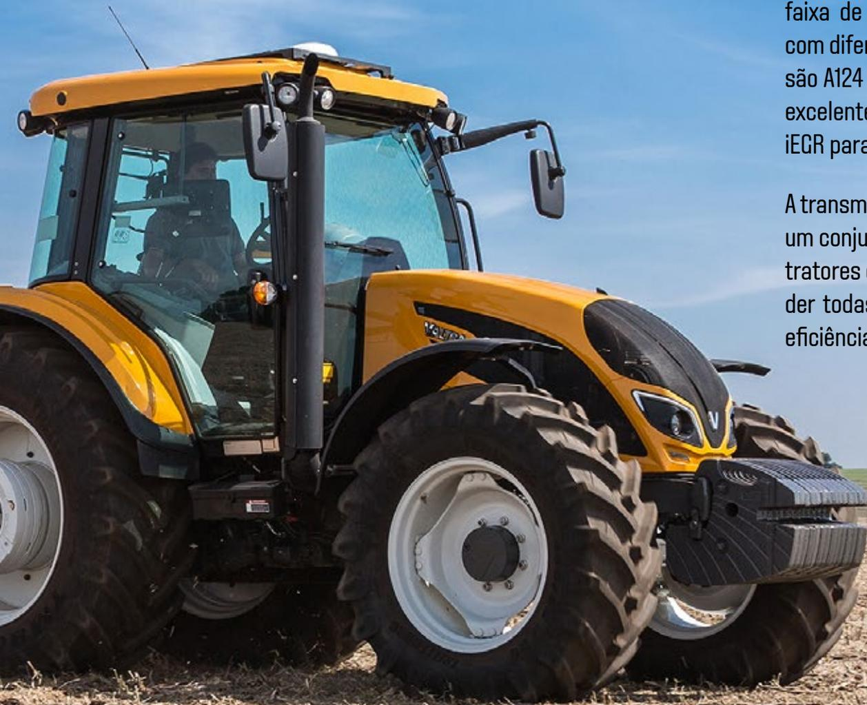
A nova geração da Série A apresenta tratores mais robustos e inteligentes. A Série A Geração 4 HiTech traz modelos com a mesma faixa de potência dos tratores com transmissão mecânica, mas com diferencial tecnológico da transmissão PowerShift. Os modelos são A124 HiTech (125 cv) e A134 HiTech (135 cv) são equipados com o excelente motor eletrônico AGCO Power de 4 cilindros e tecnologia iEGR para redução das emissões de poluentes.
