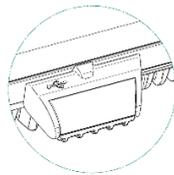
A figura abaixo mostra a parte traseira do NT01. O conector maior serve para interface de dados com o veículo da AGCO e alimentação do terminal, feita com cabo dedicado da AGCO. Os conectores circulares servem para conexão de câmeras opcionais, com interfaces dedicadas, disponíveis dependendo do veículo. O terminal NT01 não requer nenhum serviço do usuário, em caso de dúvidas, suporte ou manutenção, contate a concessionária do seu veículo ou a mais próxima.
