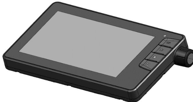
O NT03 é um terminal de dados com tela de 9 polegadas, sensível ao toque, utilizado exclusivamente em veículos da AGCO, para interface com o usuário na operação de veículo agrícola.
