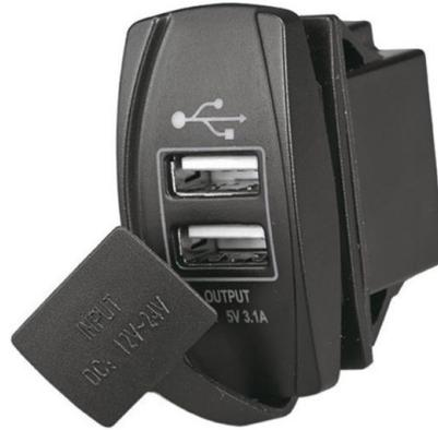
Este carregador de celular com duas portas USB pode ser instalado em certos veículos agrícolas da AGCO. Opera de 8V a 24V, com corrente de entrada máxima de 3,2A em 12V, e é capaz de fornecer 5V com corrente máxima de 3,1A em cada porta USB. A informação de tensão de entrada (“INPUT”) de 12V e 24V na frente do dispositivo não representa uma faixa de tensão, mas as tensões nominais automotivas de 12V e 24V em que o dispositivo pode operar.
